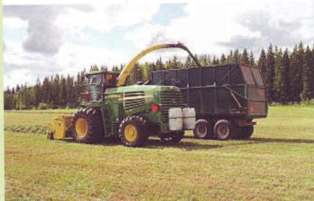
Консервант вносится с помощью насосов –дозаторов, устанавливаемых на кормоуборочную технику
